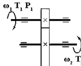
3. Прочитать кинематическую схему, определить ее элементы. Мощность на ведущем валу  $P_1 = 13$  кВт; Угловая скорость ведущего вала  $\omega_1 = 57$  рад/сек; Коэффициент полезного действия передачи  $\eta = 0,97$ ; Передаточное число передачи  $u = 8$ .
