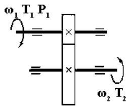
4. Прочитать кинематическую схему, определить ее элементы. Вес груза  $G = 1200$  Н; Скорость подъема груза  $v = 10$  м/сек; КПД барабана лебедки  $\eta_b = 0,9$ ; КПД цилиндрической передачи  $\eta_c = 0,98$ ; Элементы конструкции приведены на схеме.
