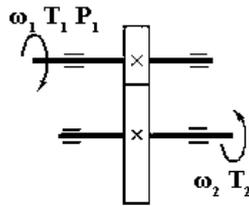
4. Прочитать кинематическую схему, определить ее элементы. Вес груза  $G = 1200$  Н; Скорость подъема груза  $v = 10$  м/сек; КПД барабана лебедки  $\eta_b = 0,9$ ; КПД цилиндрической передачи  $\eta_{ц} = 0,98$ ; Элементы конструкции приведены на схеме.
