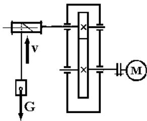
5. Прочитать кинематическую схему, определить ее элементы. Вес груза  $G = 1000$  Н; Скорость подъема груза  $v = 8$  м/сек; КПД барабана лебедки  $\eta_b = 0,8$ ; КПД цилиндрической передачи  $\eta_c = 0,98$ ; Элементы конструкции приведены на схеме.
