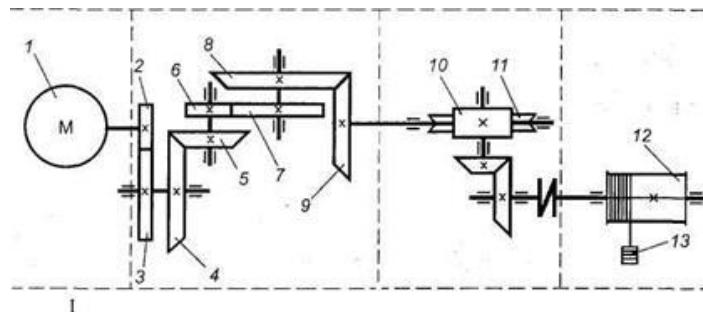
2. Прочитать кинематическую схему, определить ее элементы. Мощность на ведущем валу  $P_1 = 8 \text{ кВт}$ ; Угловая скорость ведущего вала  $\omega_1 = 40 \text{ рад/сек}$ ; Коэффициент полезного действия передачи  $\eta = 0,97$ ; Передаточное число передачи  $i = 4$ .
