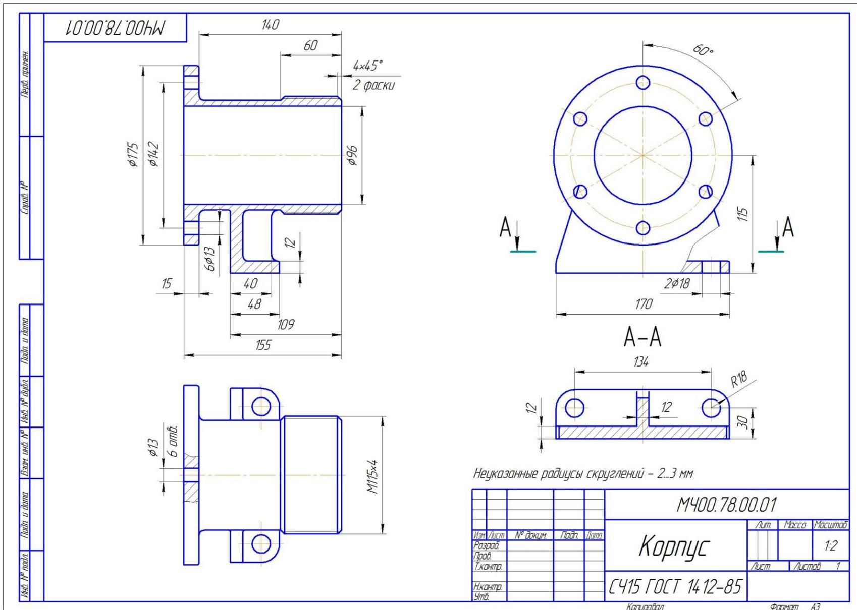
Рис. 9. Графическая работа «Деталирование чертежа» (Лист 11 – Чертежи деталей)
